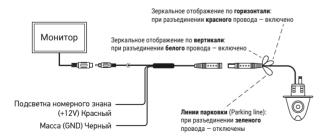
ВНИМАНИЕ! Размыкать и замыкать провода линий парковки, зеркального отображения по горизонтали и по вертикали необходимо только на отключенной от питания камере заднего вида!
